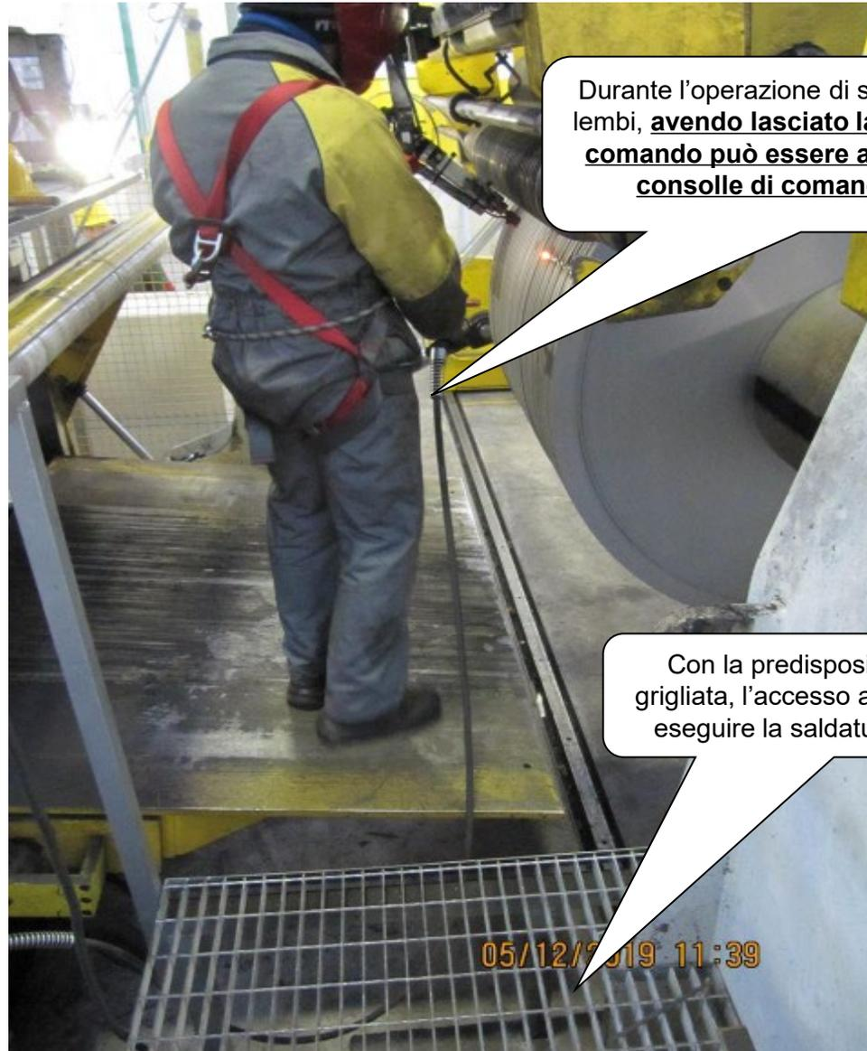
Durante l'operazione di saldatura/puntatura dei lembi, **avendo lasciato la pulsantiera, nessun comando può essere attivato dalla normali consolle di comando dell'impianto**
