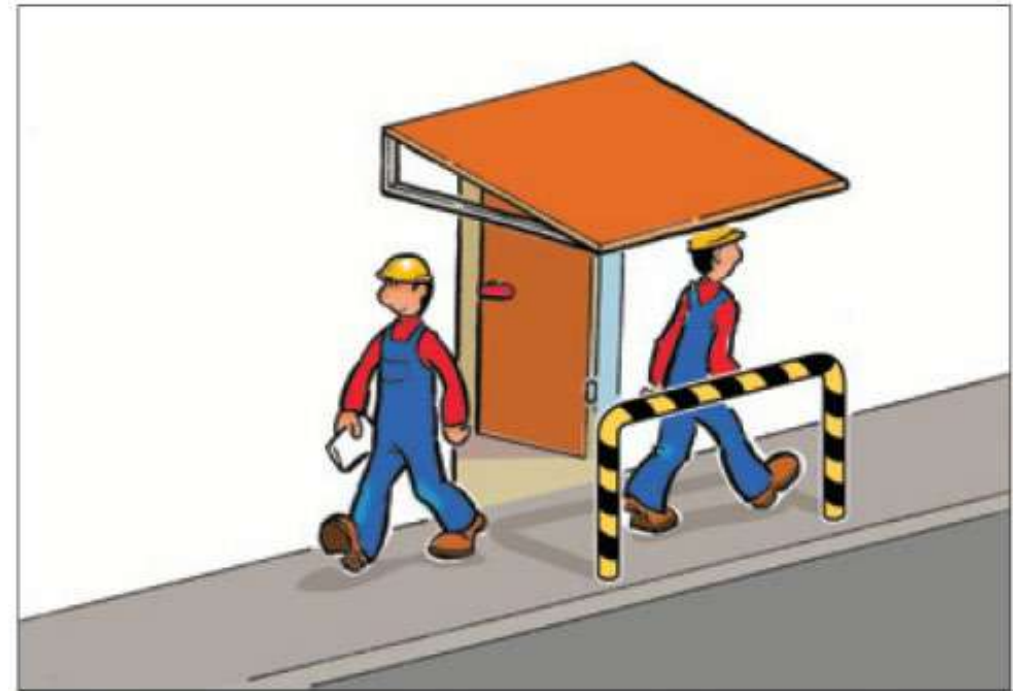
Barriera fissa conformata ad archetto ed evidenziata con bande trasversali oblique gialle e nere intervallate, a protezione della zona antistante una porta pedonale
