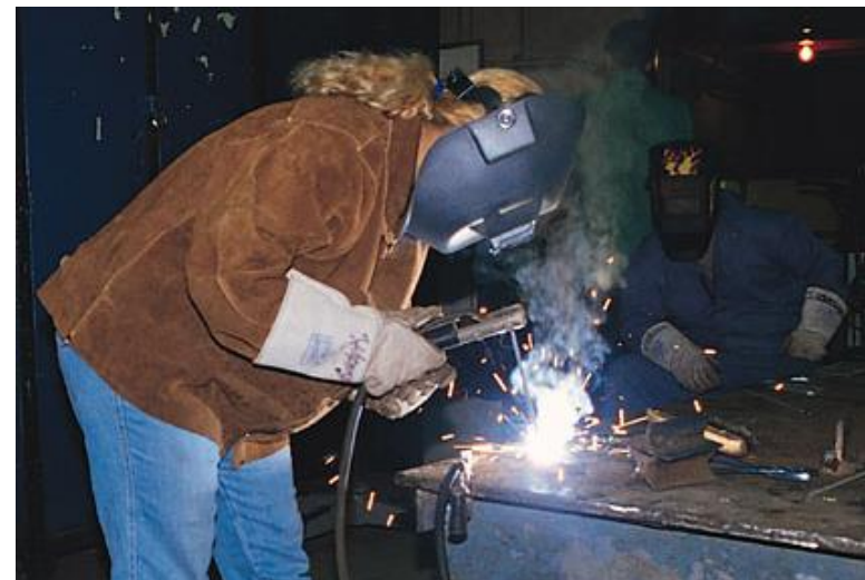
Operazioni di saldatura ad elettrodo rivestito
