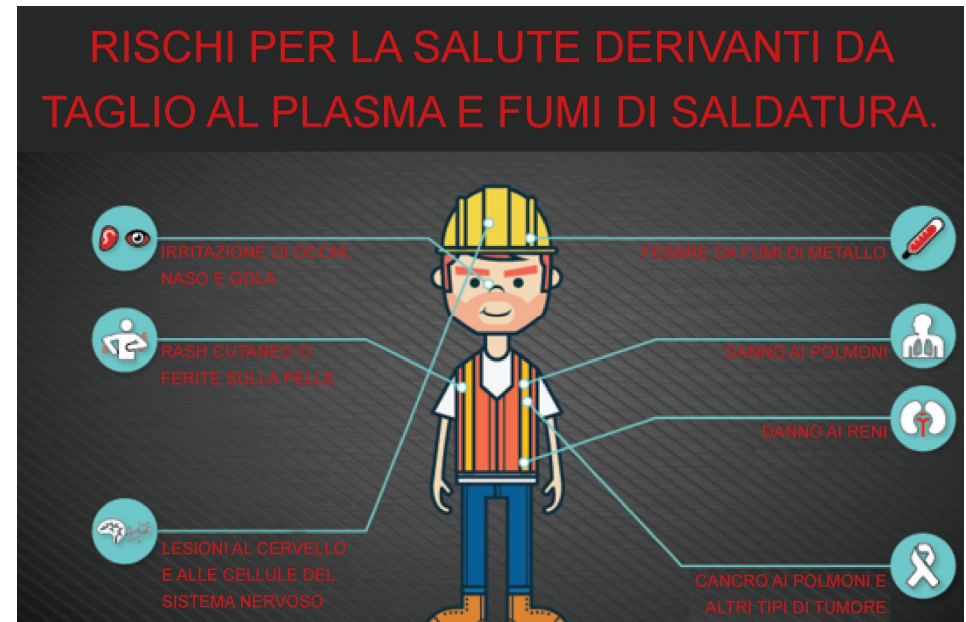
Rischi per la salute derivanti da taglio al plasma e fumi di saldatura
