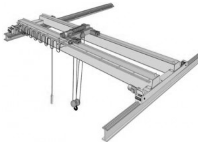
Gru a ponte
